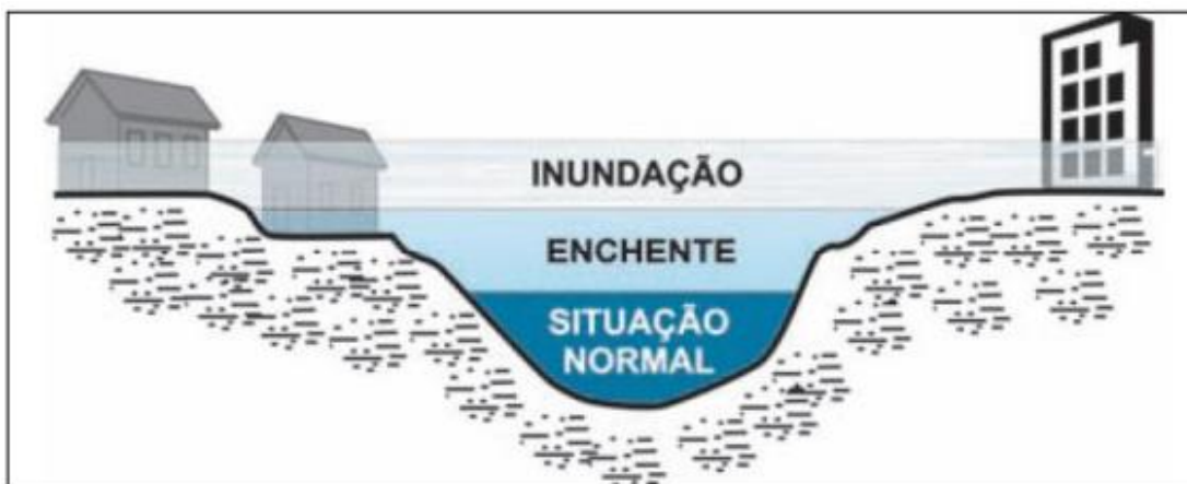
Figura 04: Perfil esquemático do processo de enchente e inundação
