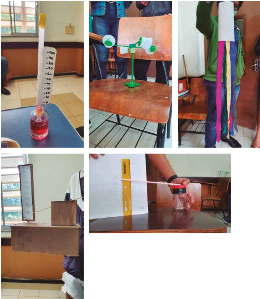
Figura 2: Aparelhos que constituem uma estação meteorológica.
